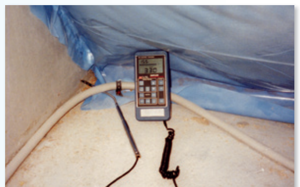
Leckageortung mit dem Anemometer
